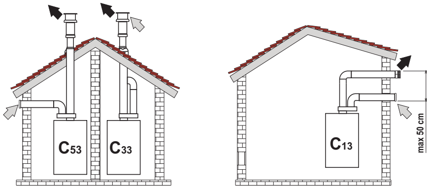
fig. 25 - Esempi di collegamento con tubi separati
